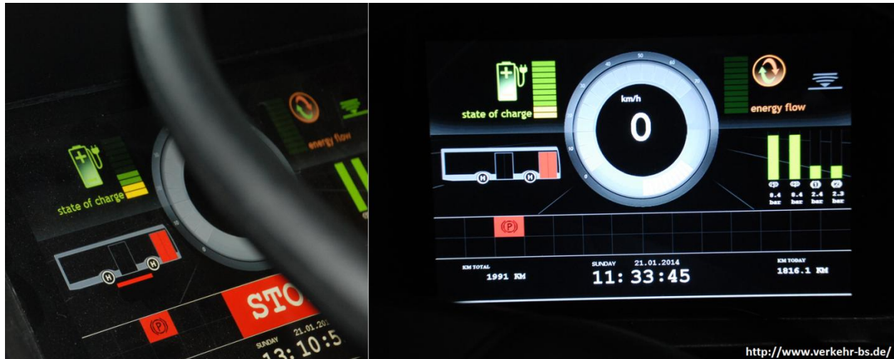
Joonis 9. Bombardier PRIMOVE tehnoloogiaga varustatud laadimissüsteemi kontroll-ekraan bussijuhi juhtpaneelis integreerituna käesoleva töö elektribussitootja bussi.
