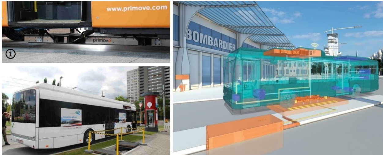
Joonis 7. Induktsioonlaadimine Bombardier PRIMOVE tehnoloogial.
