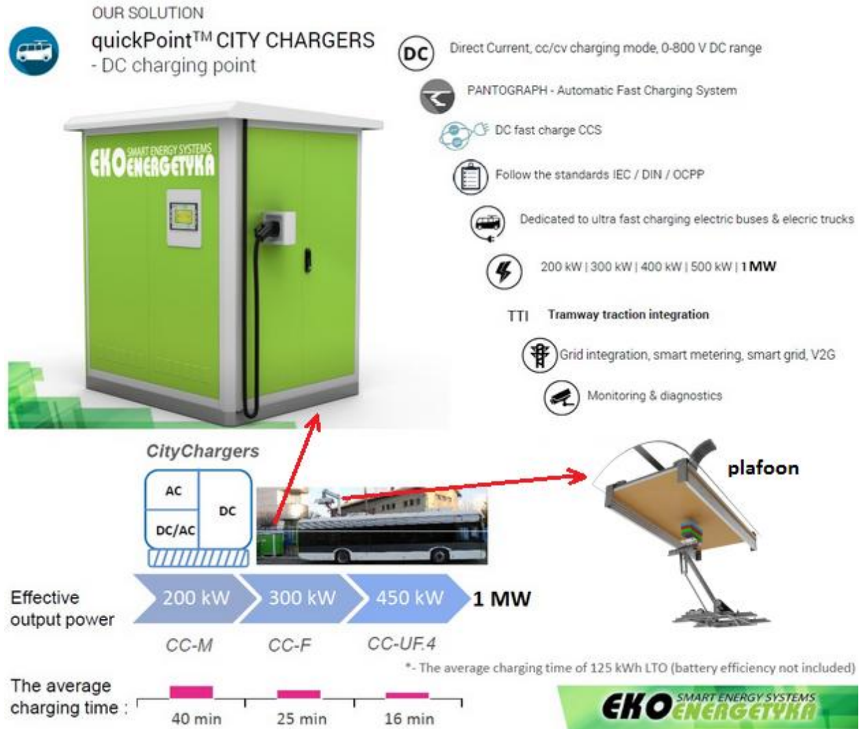
Joonis 4. Ekoenergetyka-Polska Sp. z o.o. poolt toodetavaid quickPoint™ plafooniga linnalaadija komplekt (laadimiskonteiner ja plafoon) ning selle vastavad näitajad laadimisvõimsuse 200 kW, 300 kW ja 450 kW korral.
