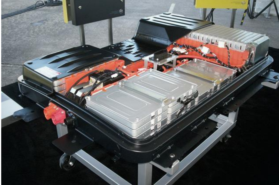
Joonis 16. Nissan Leaf elektriauto akupaketi suurus on 24 kWh 5 .
