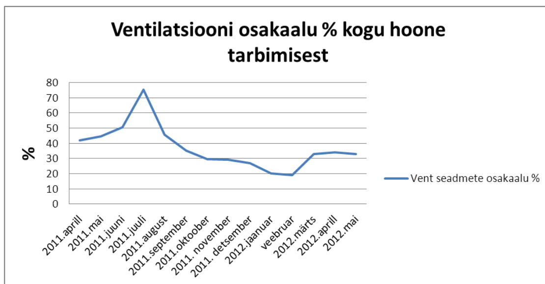
Joonis 6.3.2. Ventilatsiooni osakaalu % kogu hoone tarbimisest
